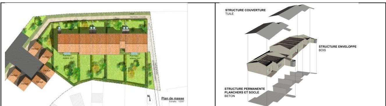
Projets de logements HLM à Lacaugne (31). Structure béton banché et isolation des murs et des toits en bottes de paille.
